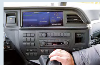
Auch im E-MAN macht der Dreh-Drück-Steller „Smart-Selection“ berührungsempfindliche Bildschirme überflüssig
