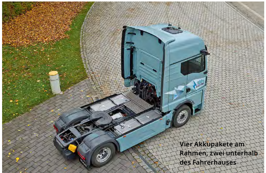
Neben den beiden Akkupaketen finden sich auch die Hochvolt-komponenten unter der Kabine
