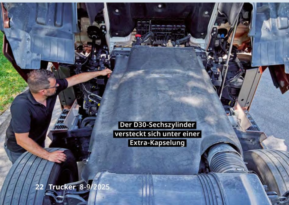
Der D30-Sechszylinder versteckt sich unter einer Extra-Kapselung
