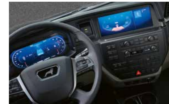
Infotainmentsystem mit 12-Zoll-Display und Bedienfeld unterhalb des Sekundärdisplays
