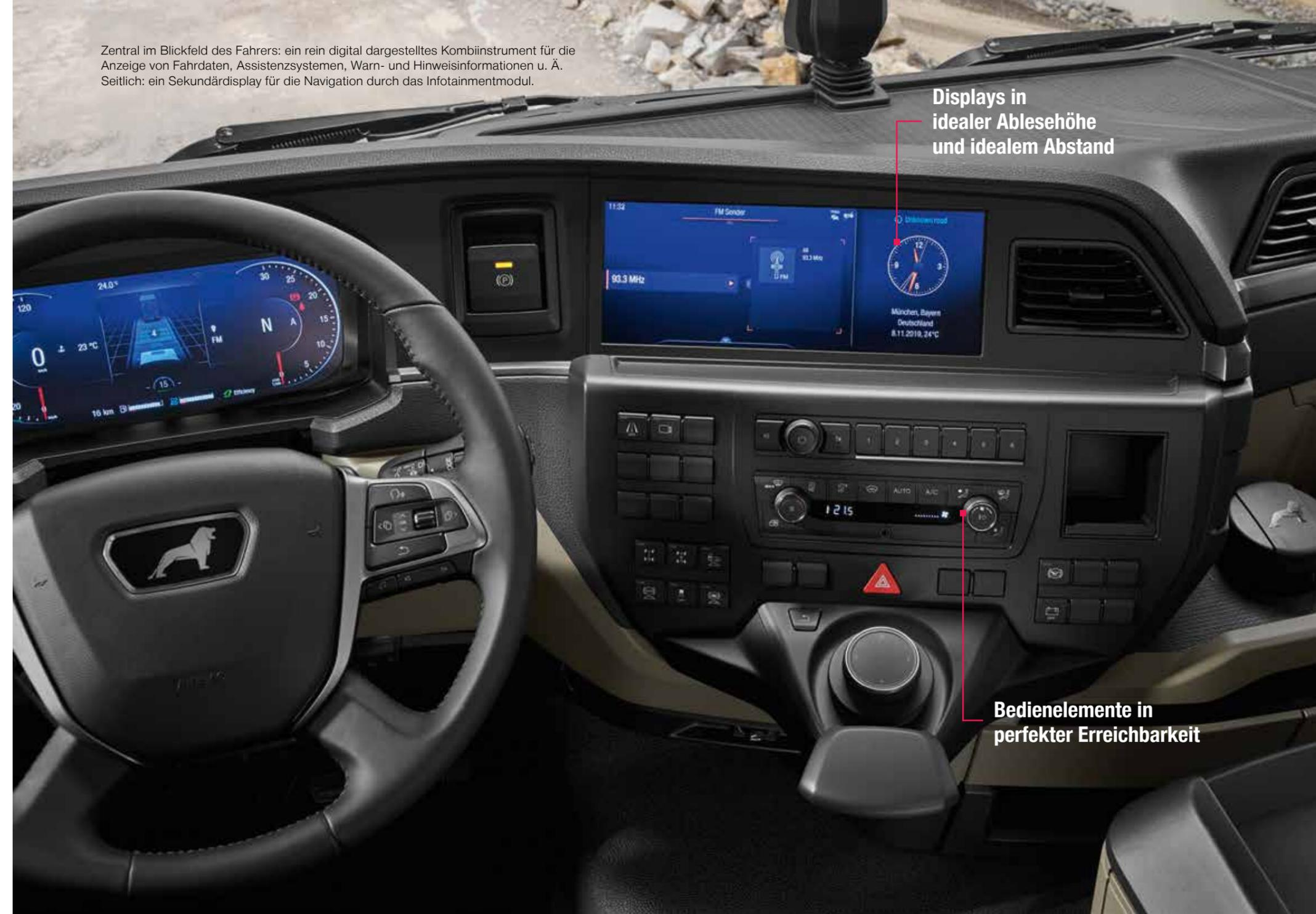
Zentral im Blickfeld des Fahrers: ein rein digital dargestelltes Kombiinstrument für die Anzeige von Fahrdaten, Assistenzsystemen, Warn- und Hinweisinformationen u. Ä. Seitlich: ein Sekundärdisplay für die Navigation durch das Infotainmentmodul.
