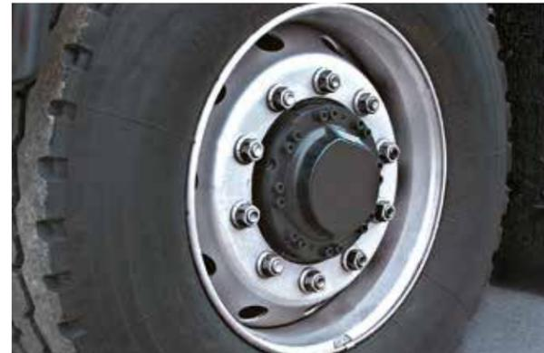
Vorderachse mit hydrostatischen Radnabenmotoren
