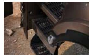
**Die bei Geländefahrten beschädigungsanfällige untere Trittstufe ist jetzt mit einer Pendelfunktion ausgestattet. Die Befestigungslaschen sind aus elastischem Kunststoff – so können sie sich bei Bodenkontakt verformen und anschließend in ihre Ursprungsform zurückkehren.**
