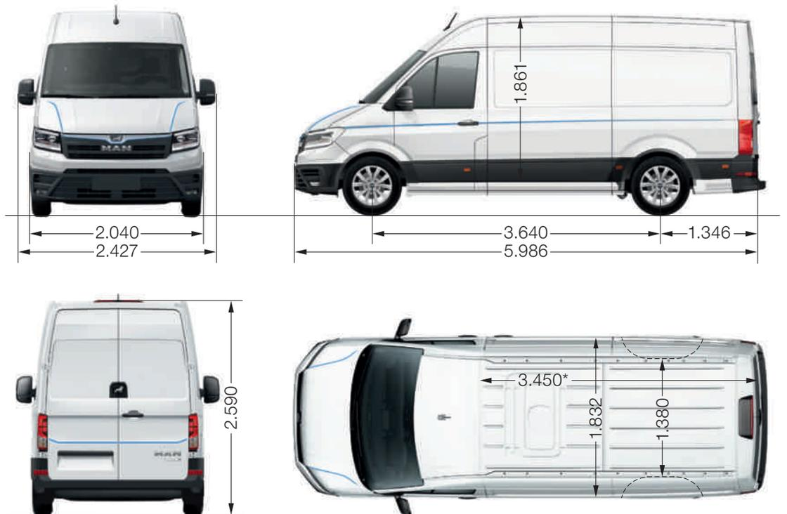
\* Länge Fahrzeugboden inkl. Unterladefähigkeit unter Trennwand. Ladelänge im oberen Bereich: 3.201 mm.
