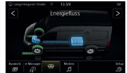
Die Energieflussanzeige informiert über den Ladezustand der Batterie sowie den Energiefluss zwischen E-Motor und Hochvoltbatterie.
