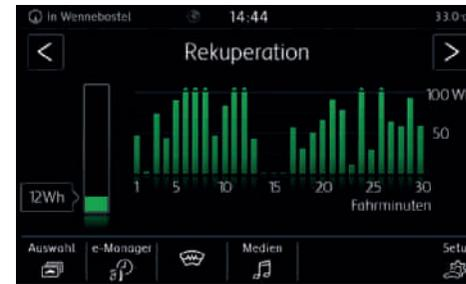
Während der Fahrt wird die Batterie in Schubphasen mittels Rekuperation auch zwischengeladen.
