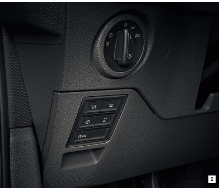
1 – Kastenwagen Plus (verfügbar in verschiedenen Fahrzeuglängen und -höhen); 2 – Separates Bedienfeld für die Aufbausteuerung, vom Fahrersitz oder von außen bedienbar; 3 – Abschleppfahrzeug
